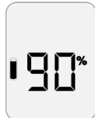
Il dispositivo poi mostra la versione del software installata e il livello di batteria rimanente. Consigliamo di cambiare la batteria non appena il livello di carica è inferiore al 50%. Si può controllare il livello della batteria in ogni momento premendo sul tasto di marcatura in modalità trasmissione.
