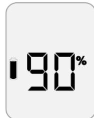
Danach zeigt das Gerät die installierte Software-Version und die verbleibende Batteriekapazität an. Wir empfehlen die Batterie auszutauschen, sobald die angezeigte Kapazität weniger als 50 % beträgt. Im Sendemodus können Sie die verbleibende Batteriekapazität mit einem langen Druck auf die Markierungstaste jederzeit kontrollieren.
