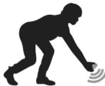
2. Rör din enhet i ett kors för att hitta den punkt där avståndsläsningen är lägst.
