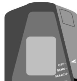
装置の電源を入れるには、(装置の右上側面にある)OFF/SEND/SEARCH選択スイッチを押し下げ、ロック ボタンがスイッチを適所に機械的にロックするのを確認します(白い矢印は「SEND」を指しているはずです)。
