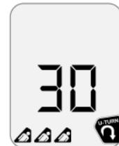
Im Falle einer komplexen Mehrfachverschüttung oder in einer Umgebung mit starken Störungen kann das Gerät Schwierigkeiten bei der Signalanalyse haben. Entfernen Sie sich in diesem Fall, um auf anderem Weg zum kritischen Standort zurückzukehren.
