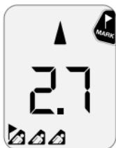
Entfernen Sie sich im Falle einer Mehrfachverschüttung beim Markieren des Verschütteten ca. 1 Meter, damit das Gerät den nächsten Verschütteten suchen kann. Die Markierung eines Verschütteten wird durch eine Fahne angezeigt.
