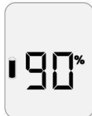
L'appareil indique ensuite la version du logiciel installé et le niveau d'autonomie restante dans la pile. Nous vous conseillons de remplacer la pile dès que le niveau indiqué descend en dessous de 50%. Un appui long sur le bouton marquage en mode émission vous permettra de consulter le niveau d'autonomie de la pile à tout moment.
