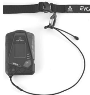
外出中は常にEVO5をファスナー付きのズボン ポケットに入れておいてください。ファスナーのスライダーは十分に閉じておき、伸縮性コードを出すのに十分なだけ隙間を開けておいてください。腰まわりでベルトを調整し、バックルで留めます。
